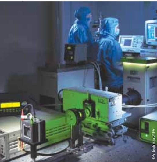
Etude sur la production d'hydrogène par photoélectrolyse de l'eau.
