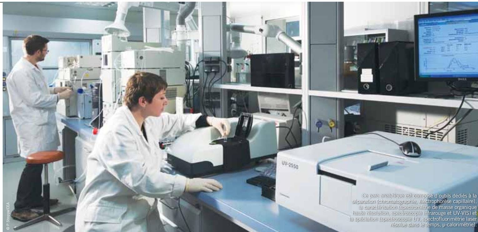
Ce parc analytique est composé d'outils dédiés à la séparation (chromatographie, électrophorèse capillaire), la caractérisation (spectrométrie de masse organique haute résolution, spectroscopie infrarouge et UV-VIS) et la spéciation (spectroscopie UV, spectrofluorimétrie laser résolue dans le temps,  $\mu$ -calorimétrie).
