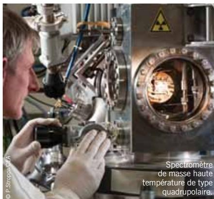
Spectromètre de masse haute température de type quadrupolaire.
