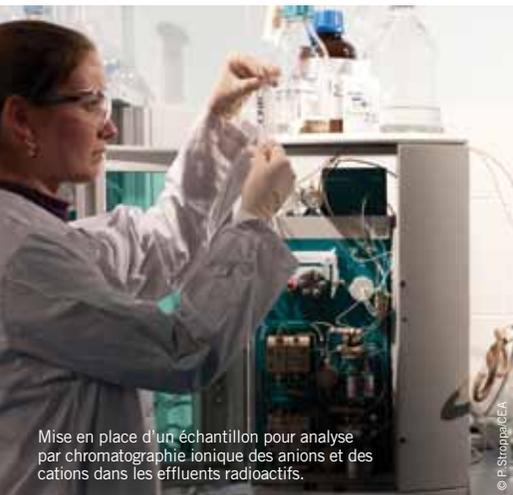
Mise en place d'un échantillon pour analyse par chromatographie ionique des anions et des cations dans les effluents radioactifs.
