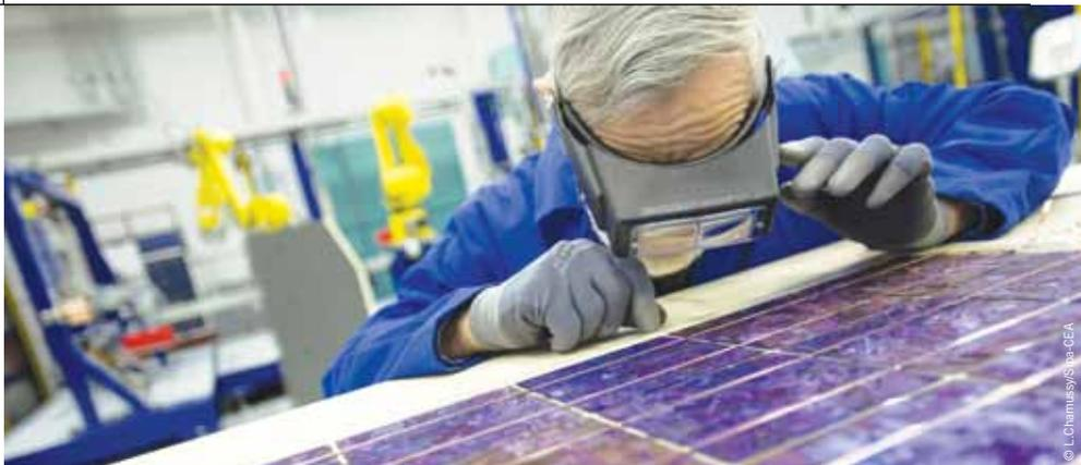
Vérification de modules photovoltaïques après encapsulation.
