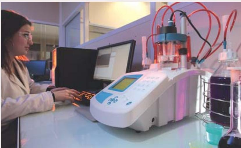
Caractérisation physico-chimique d'un lixiviat obtenu après la mise en solution des matériaux actifs de batteries Li-ion.
