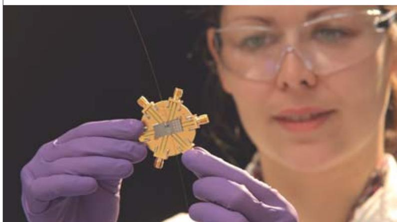
Capteurs gaz intégrant des NEMS (pour Nano Electro Mechanical Systems).
