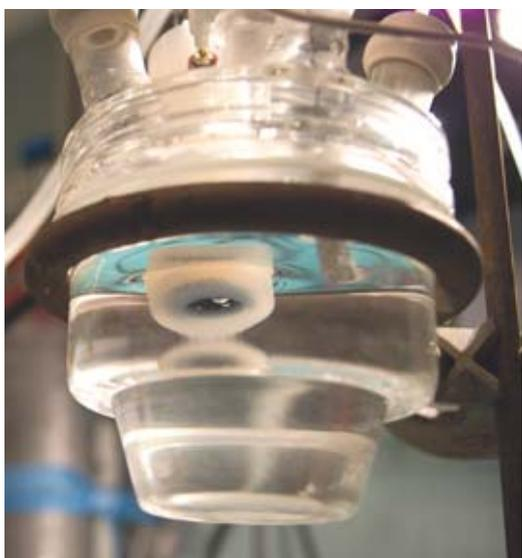
Cellule électrochimique en configuration demi-pile destinée à tester les nouveaux catalyseurs avec la technologie mise au point à l'Institut Liten.
