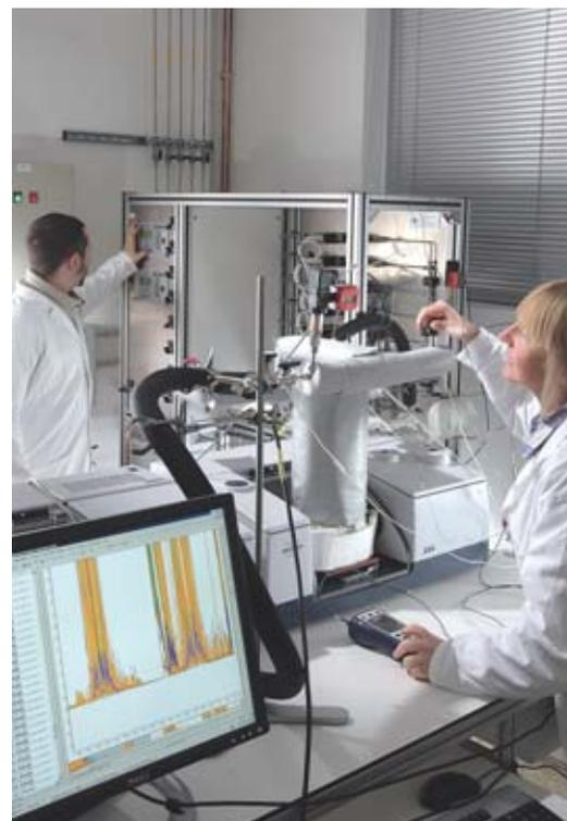
Installation d'analyse par spectroscopie infrarouge à transformée de Fourier (IRTF) permettant de mesurer les teneurs en composés inorganiques et les goudrons à l'état de traces dans le gaz de synthèse.
