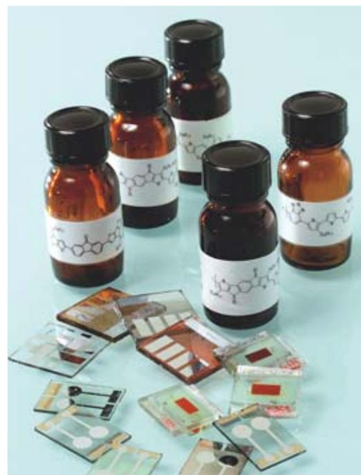
Échantillons de polymères pi-conjugués et prototypes tests de cellules photovoltaïques fabriquées à partir de ceux-ci.
