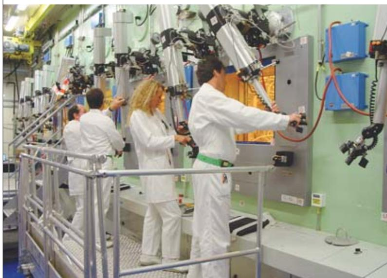
Vue de la cellule blindée du procédé CBP (Chaîne Blindée Procédé) de l'installation ATALANTE du CEA/Marcoule, où sont menés les expérimentations et les essais de démonstration de faisabilité technique des différents concepts de séparation des actinides développés.
