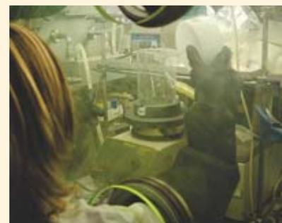
Préparation d'un essai de coprécipitation oxalique au laboratoire L15 d'ATALANTE pour la modélisation de procédé.
