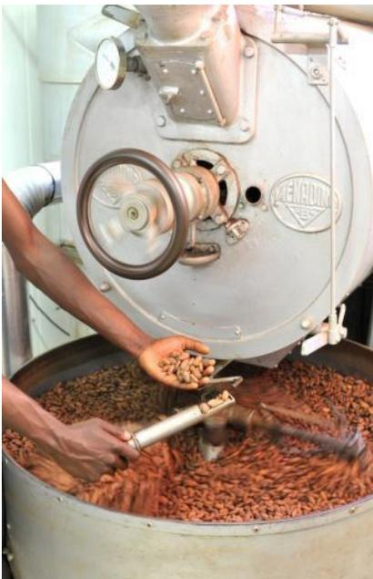
La torréfaction du cacao est proche de celle du café : on utilise des appareils à tambour, ou des systèmes à air chaud pulsé.
